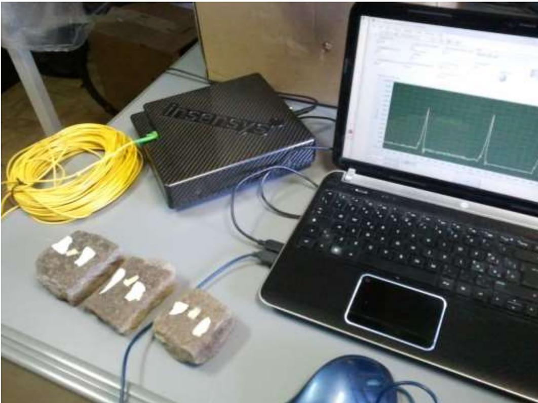
Figura 3: test acquisizione in divisione di tempo
