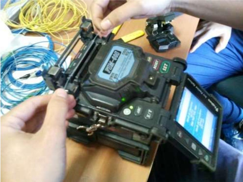
Figura 10: inserimento del termorestringente nel fornello.
