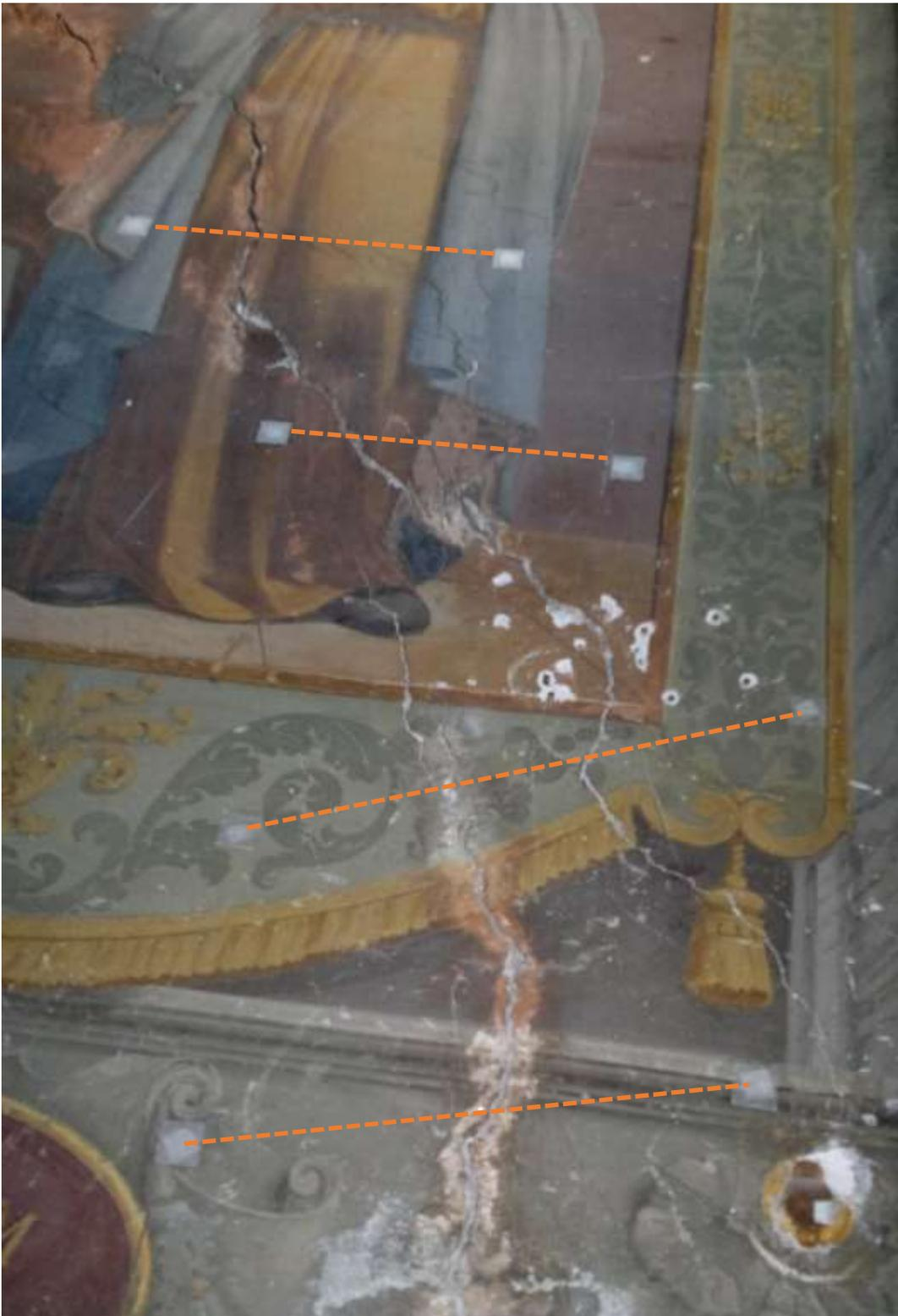
Figura 16: fessura su affresco dopo l'incollaggio di quattro sensori FBG di strain (FBG in temperatura è libero)
