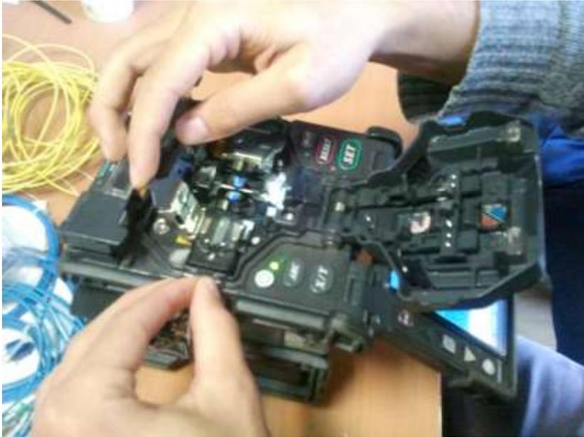
Figura 8: posizionamento della fibra nella giuntatrice.
