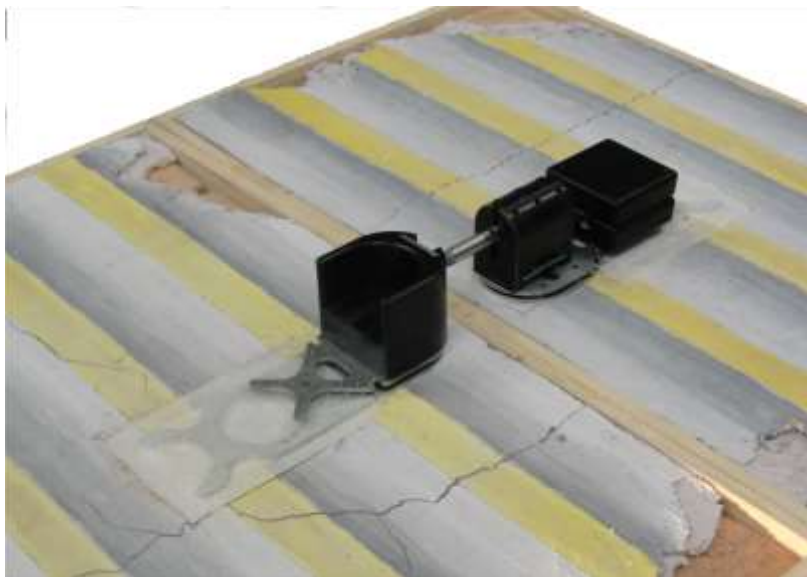
Figura 1: Prove ancoraggio sensori Wi-fi con simulacro
